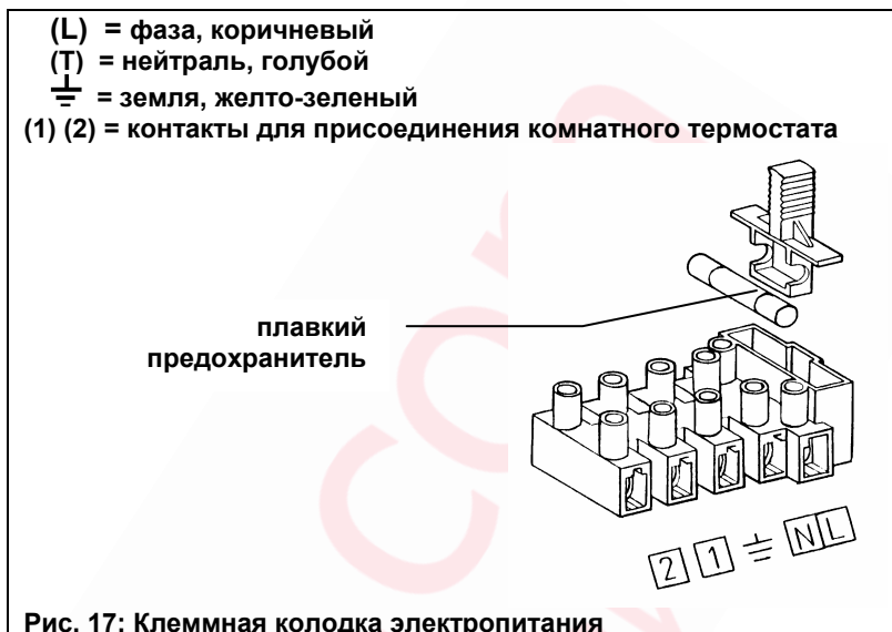
Рис. 17: Клеммная колодка электропитания
