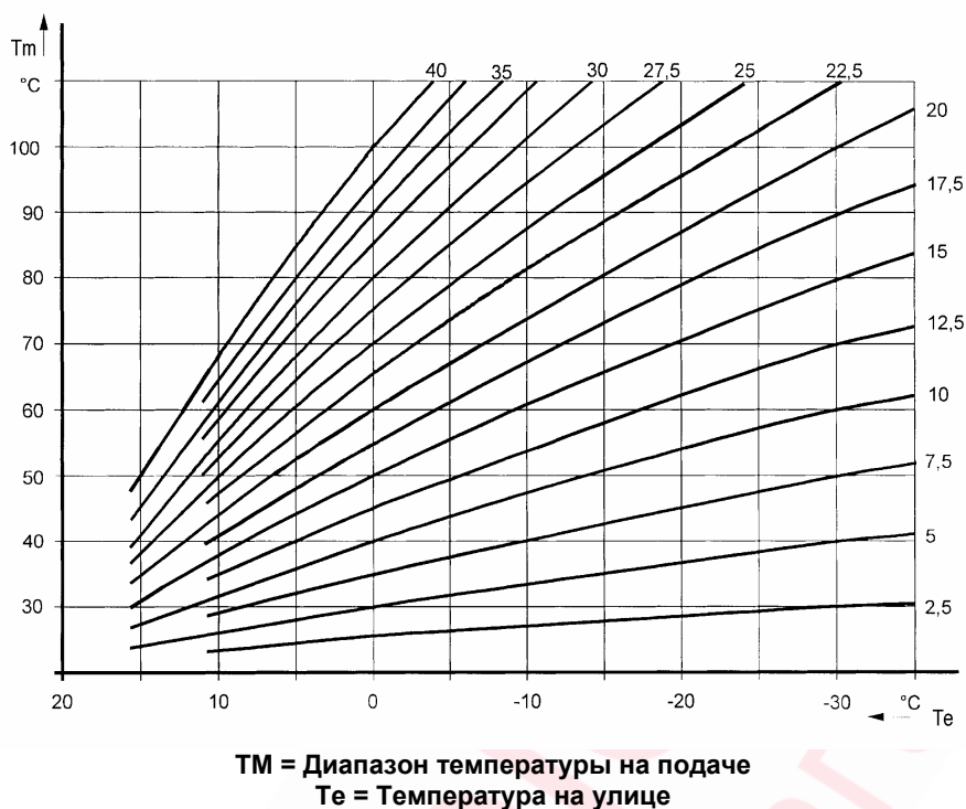
Рис. 28: Выбор рабочей кривой датчика уличной температуры при наличии климатического регулятора QAA 73
