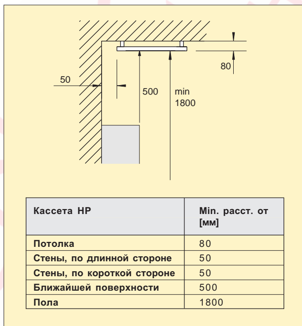
Рисунок. 2: Минимальные расстояния при установке.
