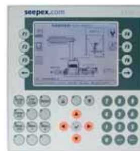
Весь процесс контролируется системой управления seepex SLCO .
