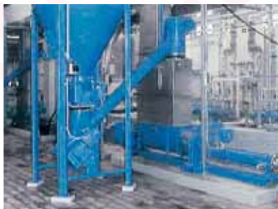
Насосы сеерех ВТ1 17-24. Продукт: обезвоженный шлам из центрифуги с примерно 30% сухого остатка. Особенность: Шлам обрабатывается в насосе известью и далее перерабатывается в сельском хозяйстве.
