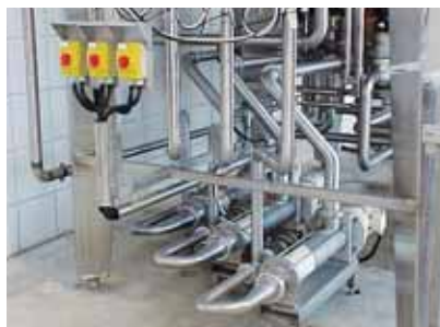
Насосы seepex BCSB 52-6L, продукт: сметана, давление: 4 бар, температура: 5-20°C производительность: 10-40 м 3 /ч
