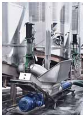
Насос seerex BT 130-6L , продукт: виноградное сусло, давление: 3 бар, производительность: 80 м 3 /ч
