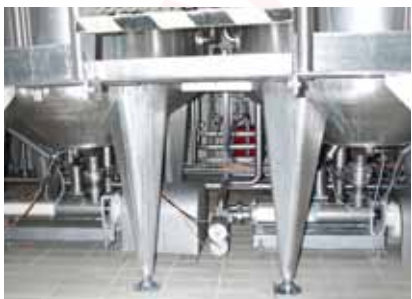
Насосы seepex BCSO 5-6L, продукт: сырая паста с кусочками овощей, вязкость: 8000 сП, температура: 60°C давление: 4 бар, CIP-чистка: при 80°C с 2%-ым раствором NaOH, при 65°C с 1,5%-ым раствором HNO 3 , производительность: 0,1-1,5 м 3 /ч
