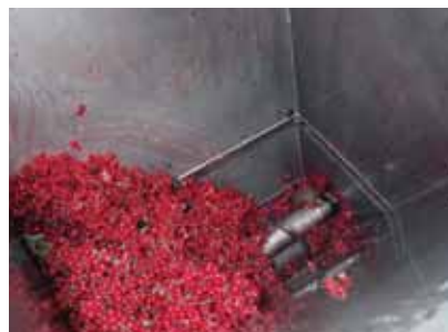
Вид со стороны загрузочной воронки насоса seerex VTM 10-12 во время размельчения и транспортировки смородины
