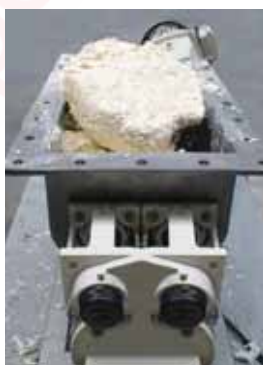
Насос seerex BTC1 10-12, для размельчения и перекачивания мягких сыров, вязкость: не текучие, температура: -от 1,3 до 2°C, давление: 7 бар, производительность: 2,3 м 3 /ч
