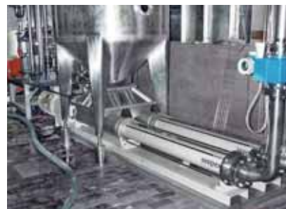
Насос seepex BT 35-24 , продукт: морковная мезга из танка для дегазации к нагревателю, температура: 70°C, давление: 20 бар, производительность: 5-10 м 3 /ч
