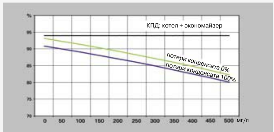
Уменьшение КПД парового котла мощностью 4000 кВт, 10 бар в зависимости от концентрации солей в питательной воде
