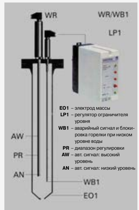
Объемный электрод с ограничителем уровня воды
