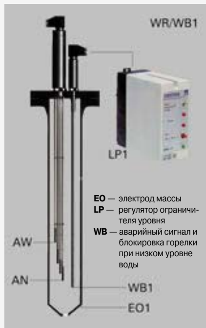
Универсальный полиэлектрод для парового котла высокого давления
